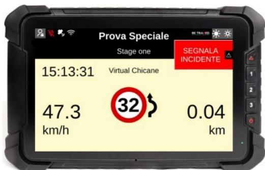
Una volta raggiunta la velocità target indicata, il dispositivo mostra la schermata "Go" segnalandovi che è possibile riprendere la velocità normale e continuare la prova speciale.
